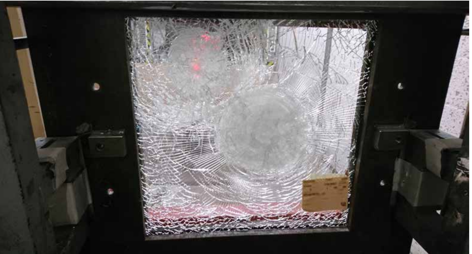
Testreihe mit dem Sicherheitsglas in den Laboren der Schott Technical Glass Solutions GmbH.
