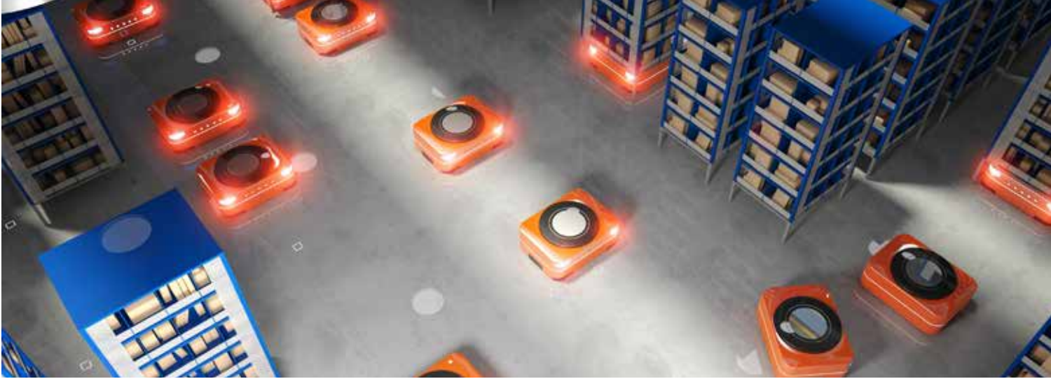
Mobile Roboter, die in einem Warenlager die Logistik übernehmen, könnten zukünftig über Li-Fi-Hotspots miteinander kommunizieren.
